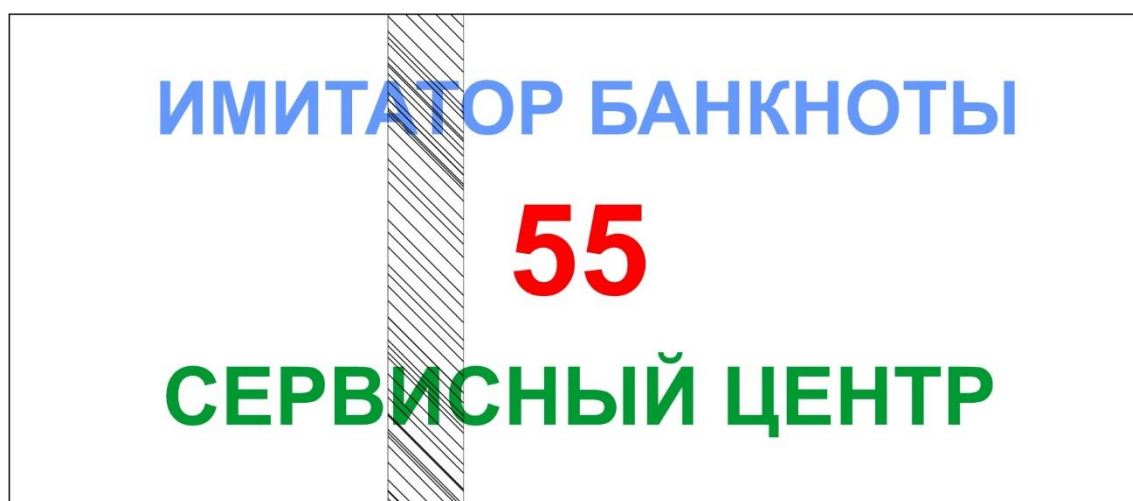
Рис.12 Пример тестового образца имитатора банкноты по ветхости с наличием на поверхности клеящей ленты
