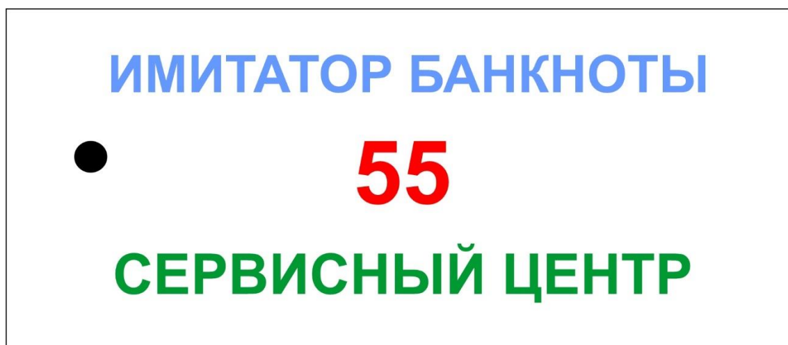
Рис.11 Пример тестового образца имитатора банкноты по ветхости с отверстием
